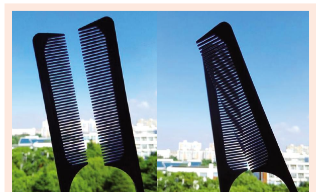
图一：拿起两把梳子（左图），将其重叠并相互转过一个小角度，便能看到明暗相间的条纹——莫尔条纹（右图）
